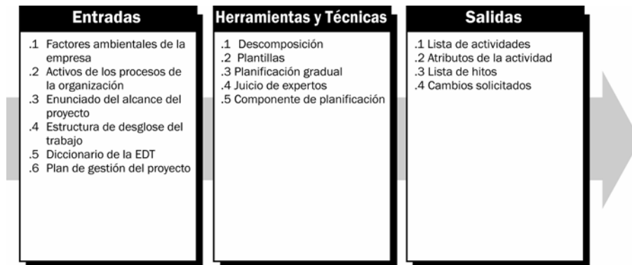
Figura 6-3. Definición de las Actividades: Entradas, Herramientas y Técnicas, y Salidas
