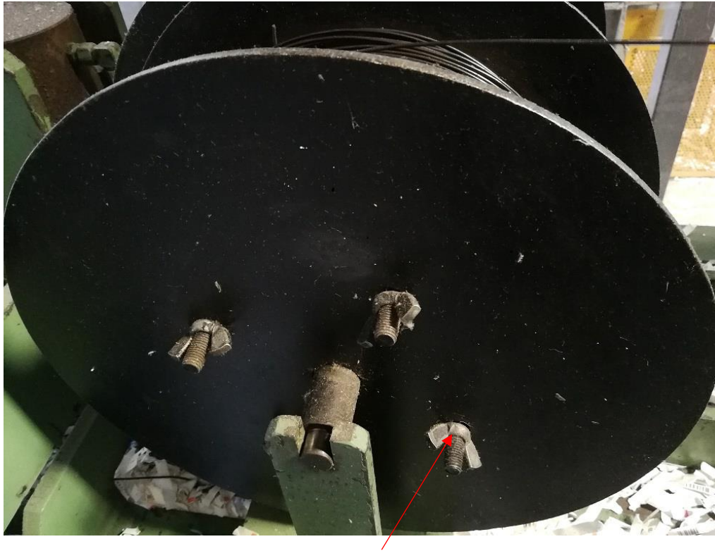
Carrete en su soporte, vista de las palomillas y tapa lateral
