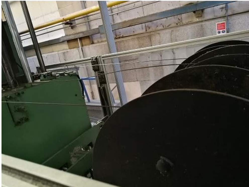
Carretes delanteros de alambre, sobre tunel empacadora.
