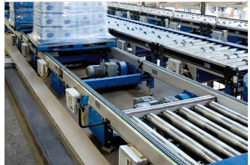
Detalle de un transportador de cadenas.
