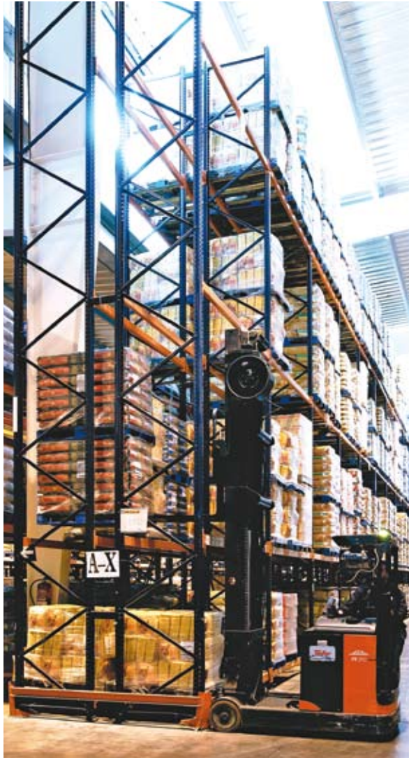
Imagen de una carretilla retráctil de doble fondo utilizada en un almacén de productos alimentarios de gran consumo. Fuente: Mecalux.
