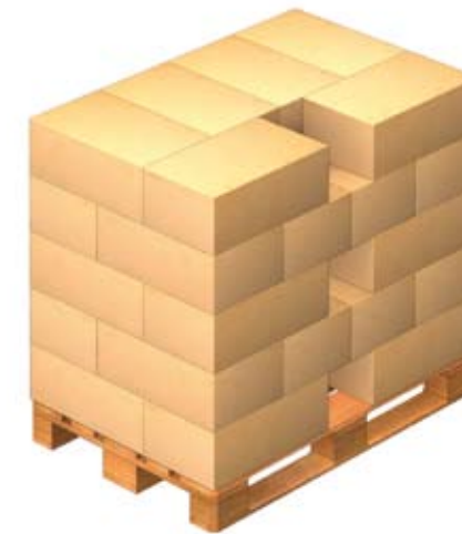
Ejemplos de disposición para formar unidades de carga, mediante capas entrelazadas de embalajes que son submúltiplos de la paleta.
