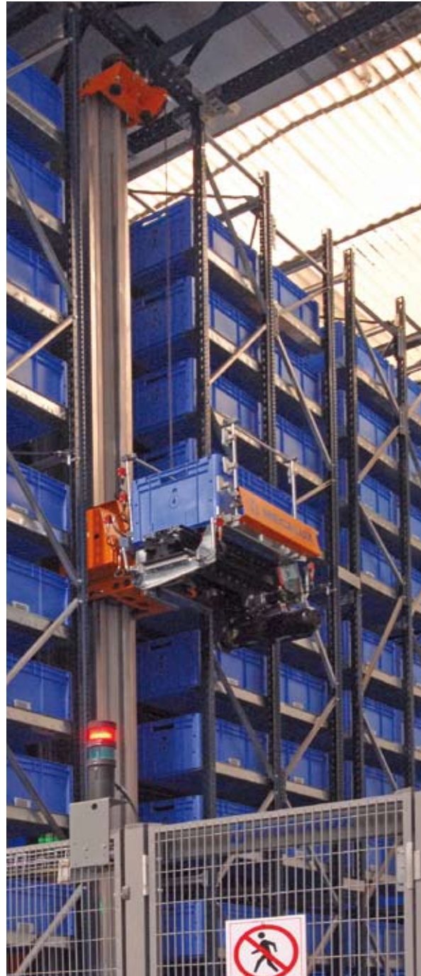
Arriba: almacén de componentes eléctricos. Izquierda: imagen de un transelevador monocolumna para cajas.
