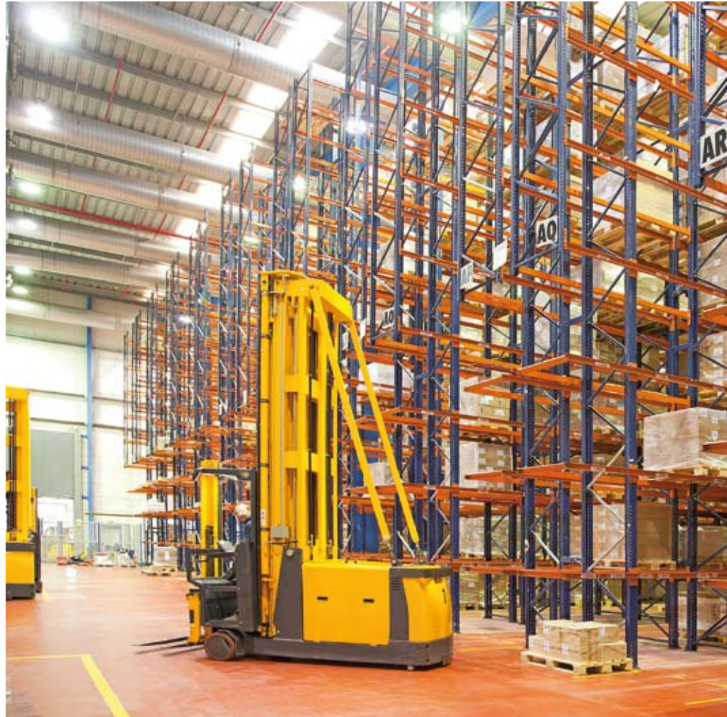
Carretilla de tipo trilateral. Fuente: Mecalux.
