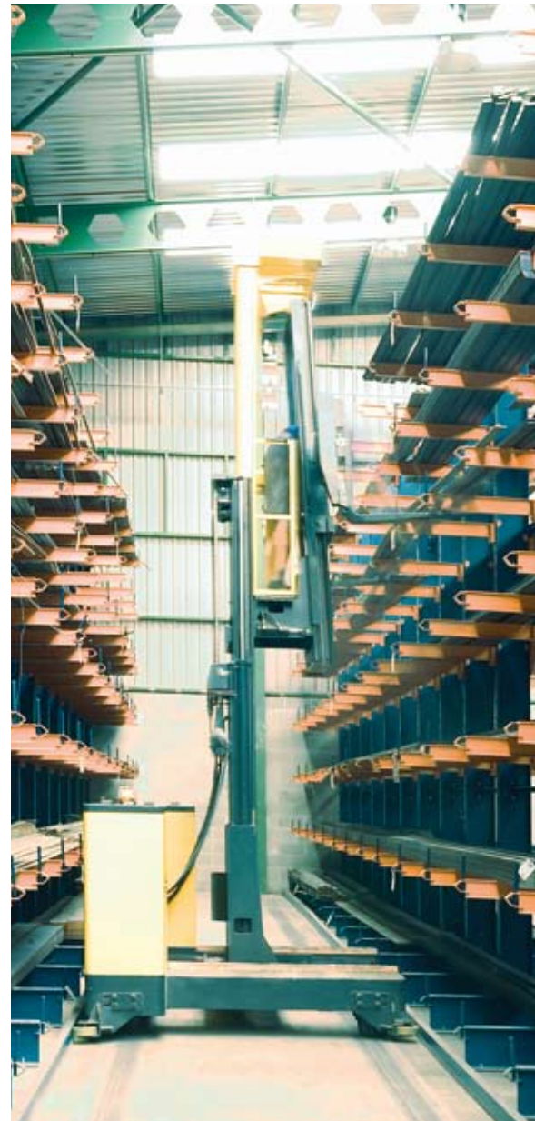
Imagen de una carretilla retráctil de carga lateral en un almacén de perfiles metálicos. Fuente: Mecalux.
