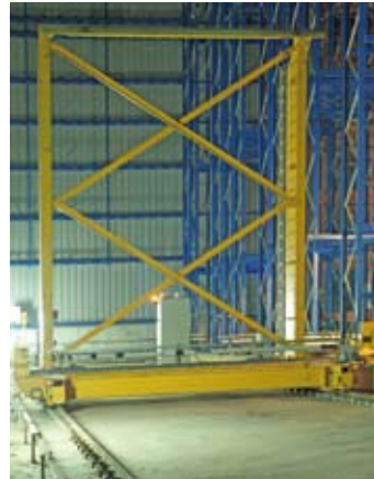
Puente de trasbordo en almacenes automáticos. Fuente: Mecalux.
