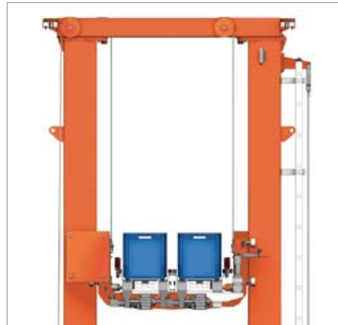
Detalle de un transelevador bicolumna para cajas.
