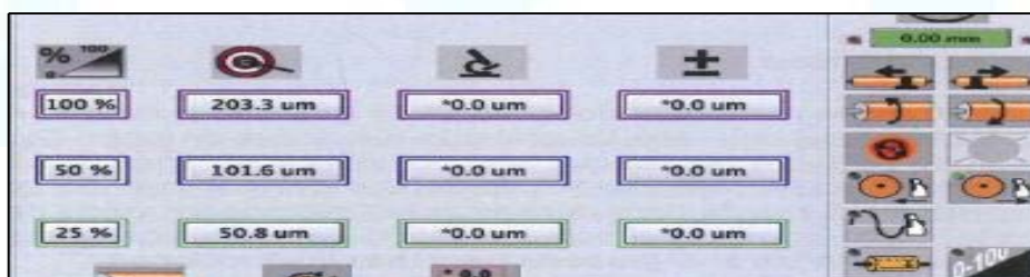
Curva de corrección de 3 puntos en la página de corrección de medios tonos
