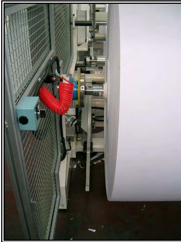
Figura 5-55 Sistema de descarga de la bobina del bobinador
