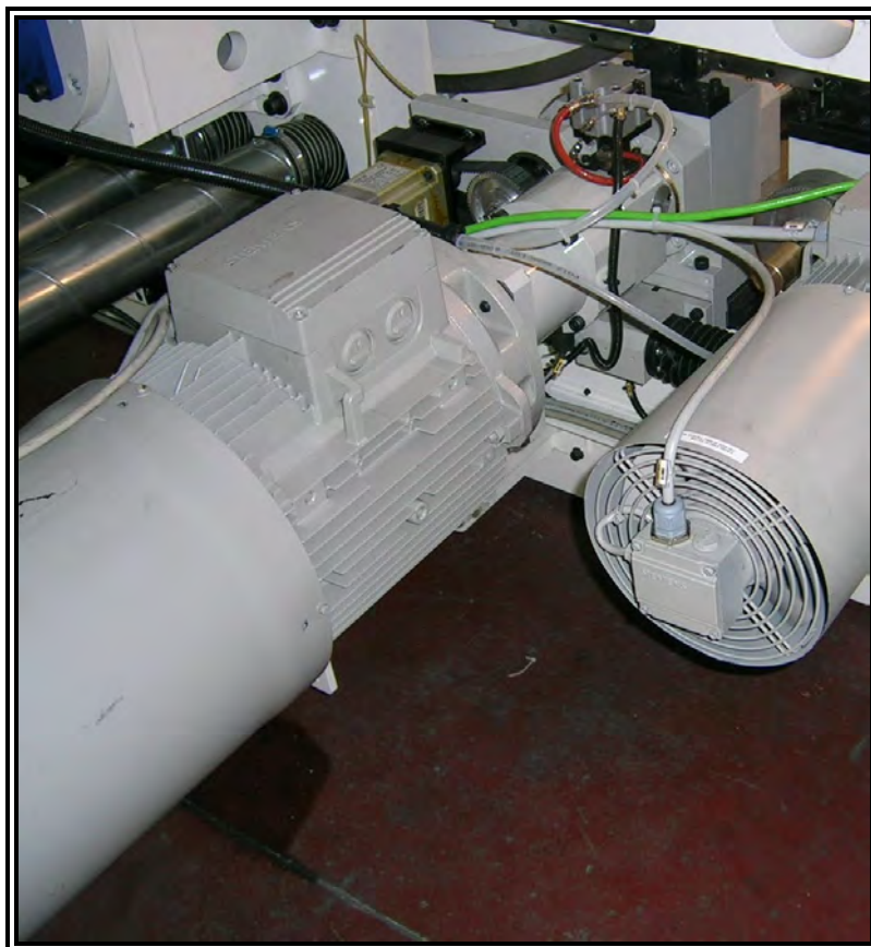
Figura 5-9 Motorización del mandril portamangas
