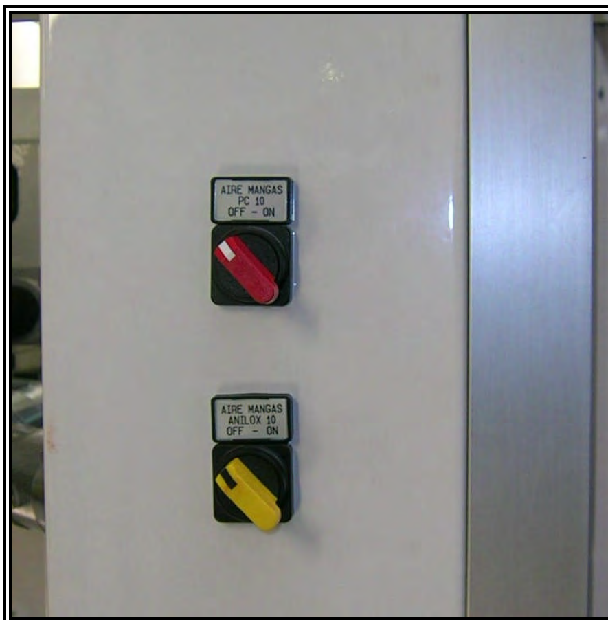
Figura 5-41 Mandos neumáticos dentro de los cárteres del grupo impresor
