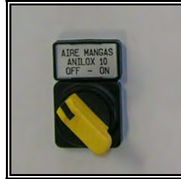
Figura 5-27 Selector neumático para el cambio de manga
