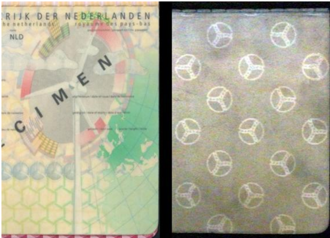
Visto con luz normal (izquierda) y con luz coaxial (derecha)
