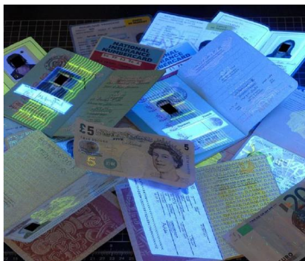
Imagen bajo LUZ ULTRAVIOLETA: las partes falsificadas de los documentos presentan una fluorescencia más brillante
