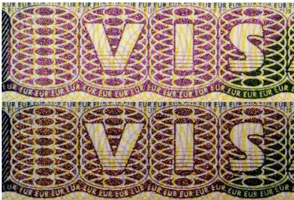
Tinta ópticamente variable calcografiada
