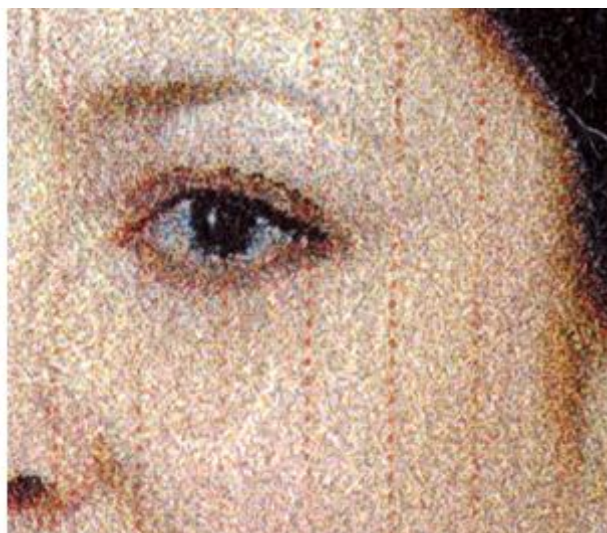
Incorporación de los datos personales y la fotografía mediante impresión por chorro de tinta
