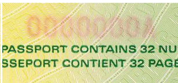
Parte de la tinta de la numeración ha sangrado a través del soporte papel y se puede ver por el otro lado
