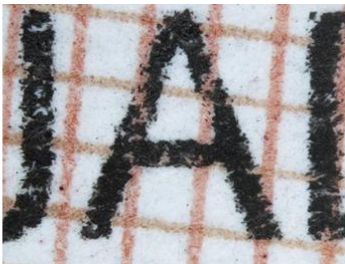
Incorporación de los datos personales y la fotografía mediante impresión por chorro de tinta
