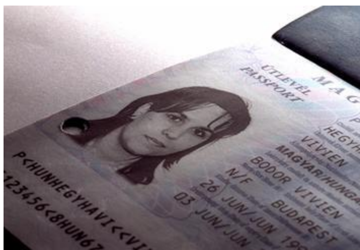
Imagen incorporada mediante grabado por láser
