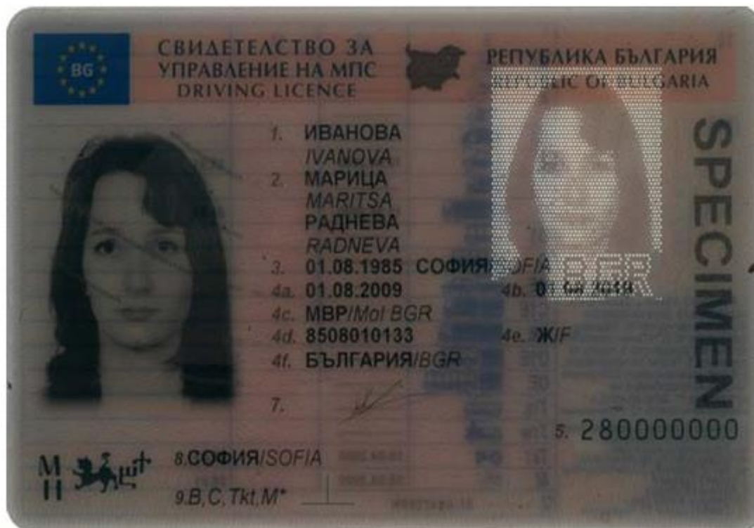
Fotografía secundaria (fantasma) perforada por láser
