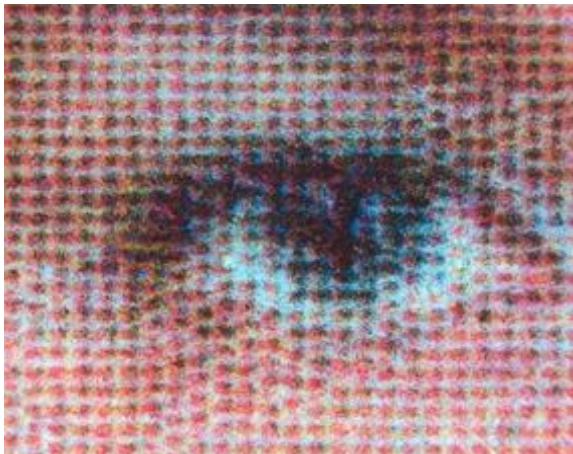
Técnica de incorporación de los datos personales y la fotografía: impresión por láser
