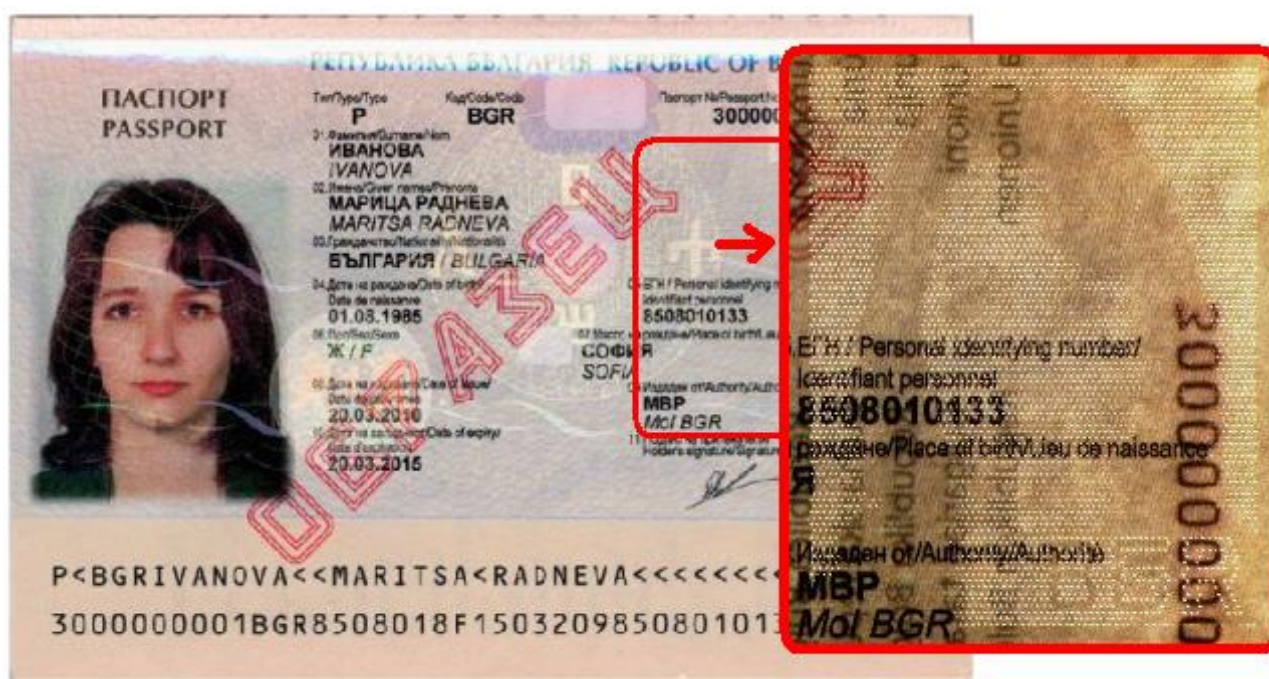
Fotografía secundaria (fantasma) perforada por láser vista con luz transmitida (en el lado derecho)
