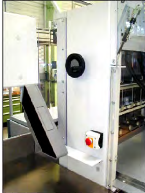
Rueda de mano para el ajuste de altura de los pies de apriete, interruptor de emergencia en el montante
