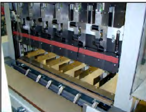
¡Mesa abierta! Guía inferior de la cinta, unidades de soldadura en la mesa
