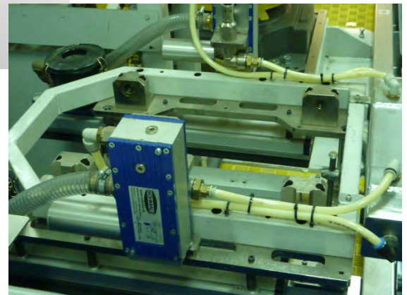
Herramienta auxiliar utilizada por el Robot para colocar los pal es.
