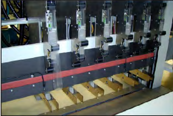
¡Cubierta quitada! Empujador, cajón de mesa, mesa con perno de fijación
