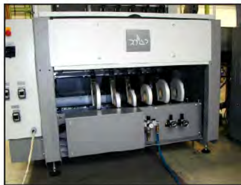
Casetes del carrete de cinta abajo, unidad de mantenimiento, regulador de presión para tensión de cinta arriba/abajo
