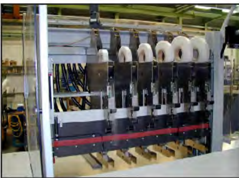
¡Mesa abierta! Guía inferior de la cinta, unidades de soldadura en la mesa
