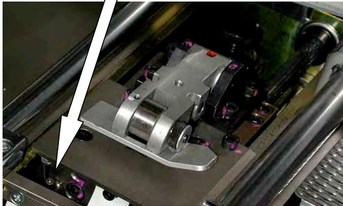
※ Lubricar ambos lados, operación y accionamiento.
