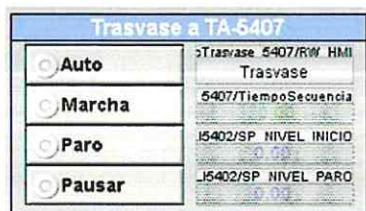
AUTO: trasvase automáticamente en función del nivel de Alimentador
