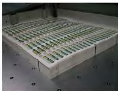
El papel está con aire entre los pliegos en la vibradora Exfoliar la esquina izda. delantera
