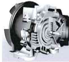
Fig. 12 Esquema de un compresor de scroll
