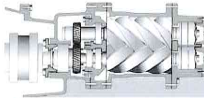
Fig. 10 Esquema de un compresor de tornillo
