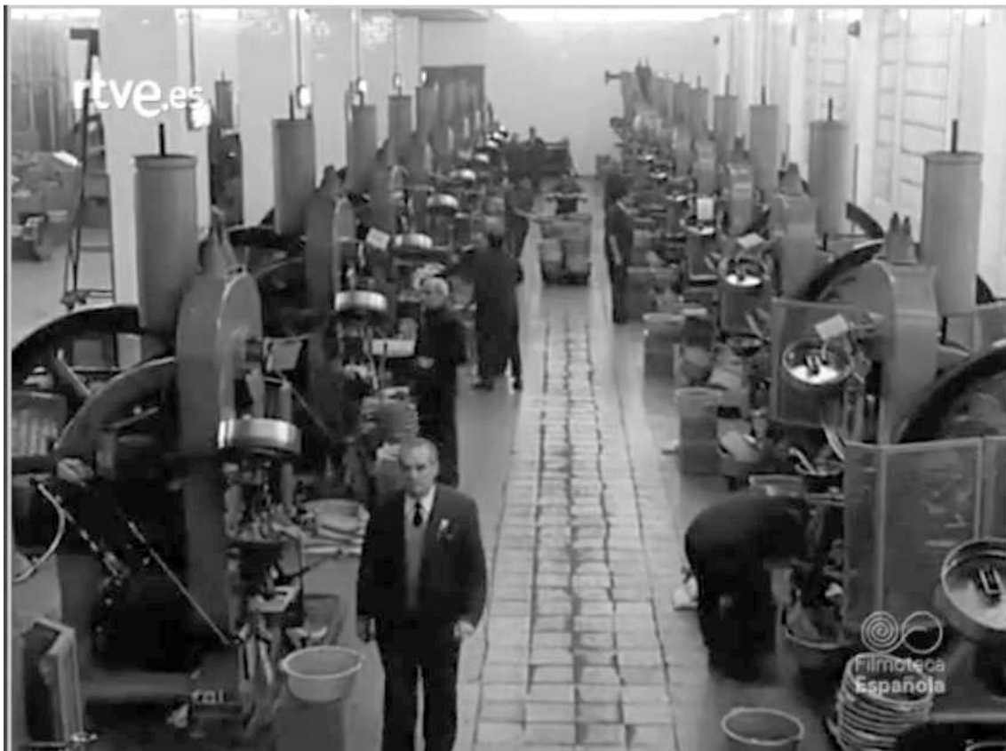
Ilustración 1: Sala de acuñación Madrid, FNMT. 1976 (NODO). Seguramente prensas Taylor & Challen, fabricadas en la Naval.
