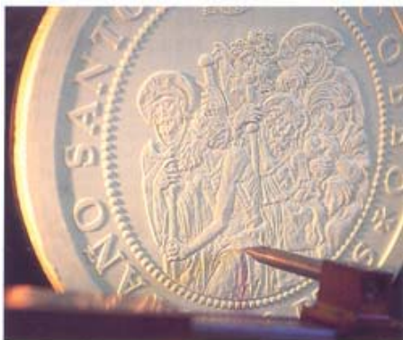
Ilustración 49 – Plástico siendo trazado en el pantógrafo
