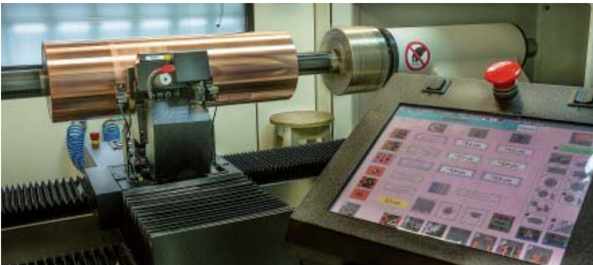
Grabadora de cilindros para impresión en huecograbado/ Cylinder engraving machine for photogravure printing
