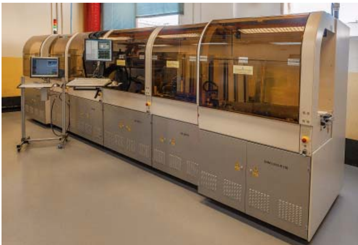
Máquina de revisión automática de tarjetas/ Automatic card-checking machine
