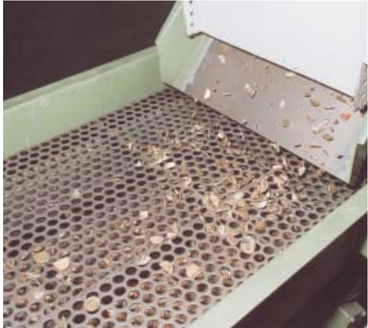
Una criba separaba los fragmentos que tenían el tamaño adecuado de los que eran demasiado grandes.
