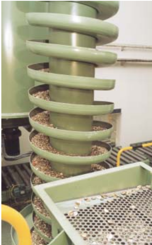
Al final de la criba los fragmentos demasiado grandes eran enviados de nuevo al proceso de corte.
